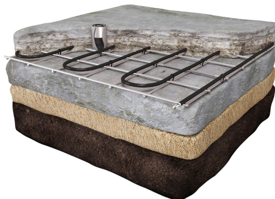
Montare în beton
